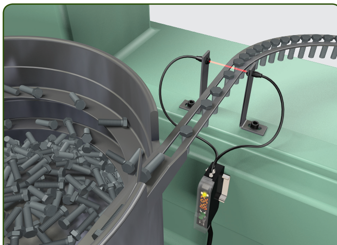
Rilevamento di piccoli pezzi: il sensore in fibra ottica 45FPL è utilizzato per assicurare il deflusso continuo di piccoli pezzi in uscita da un alimentatore.
